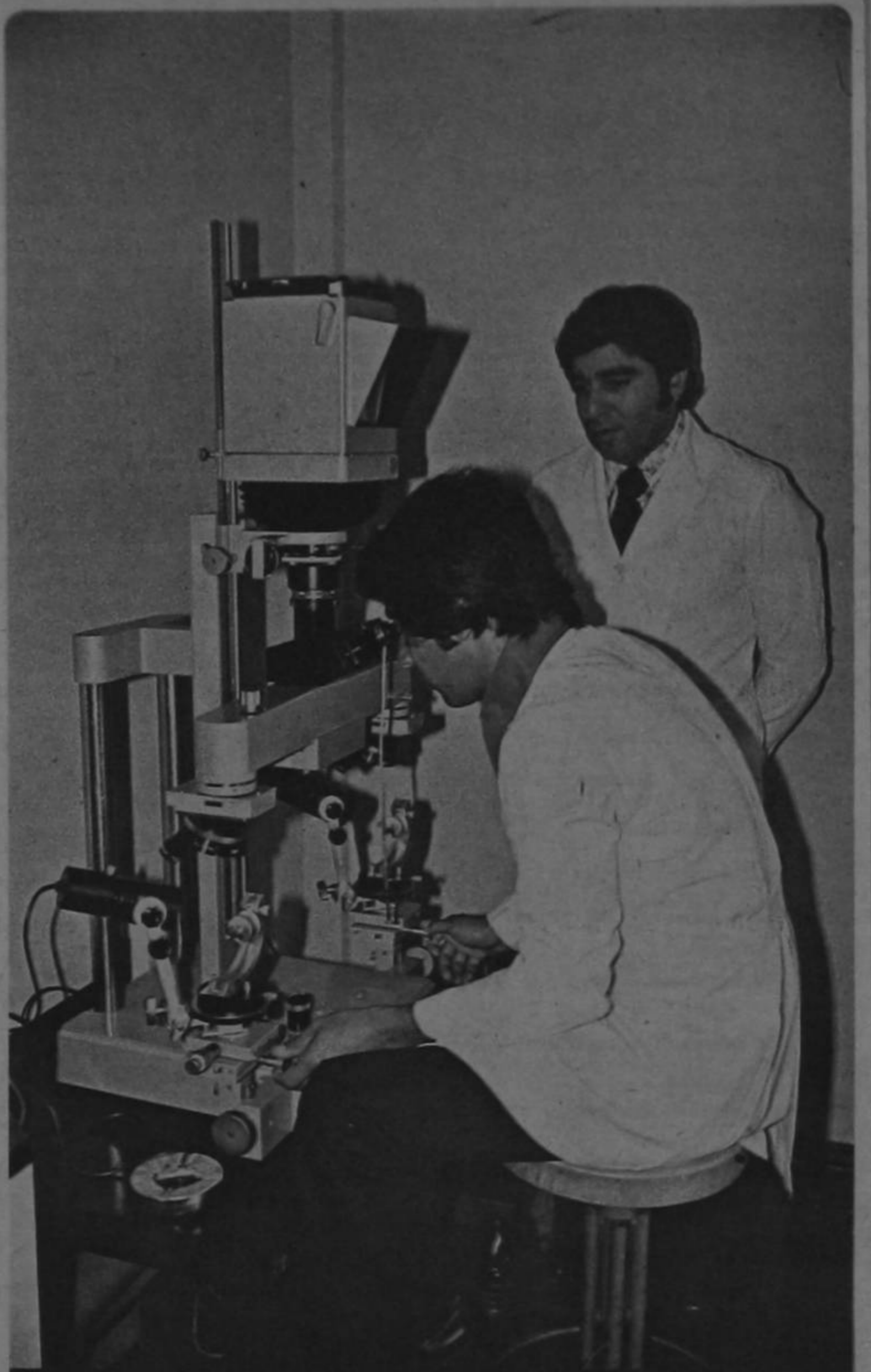
SECCION DE BALISTICA del Organismo de Investigación Judicial. El Lic. Luis Viquez, compara dos proyectiles en el microscopio de comparación balística. Lo observa El Dr. Gustavo Castillo Montoya, Jefe de la Sección de Investigaciones Físicas, del Departamento de Laboratorios.
